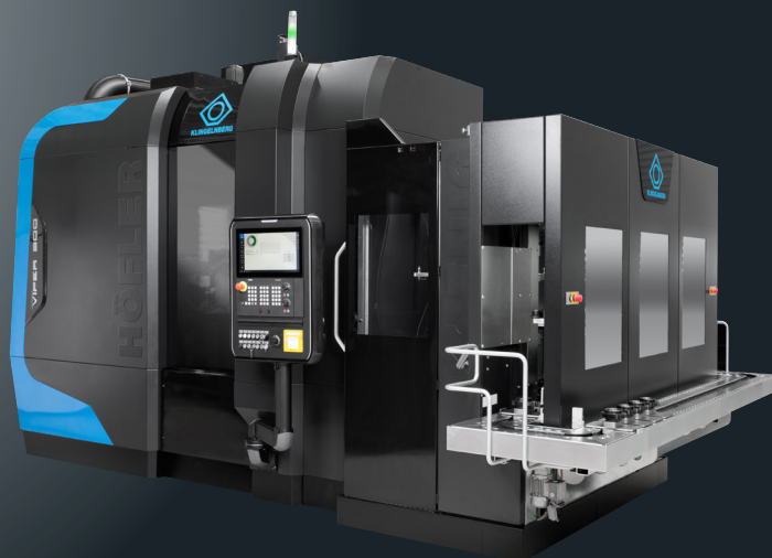
ヘフラー創成研削盤Speed Viper300とKOENIG製コンパクトローダの組み合わせ
