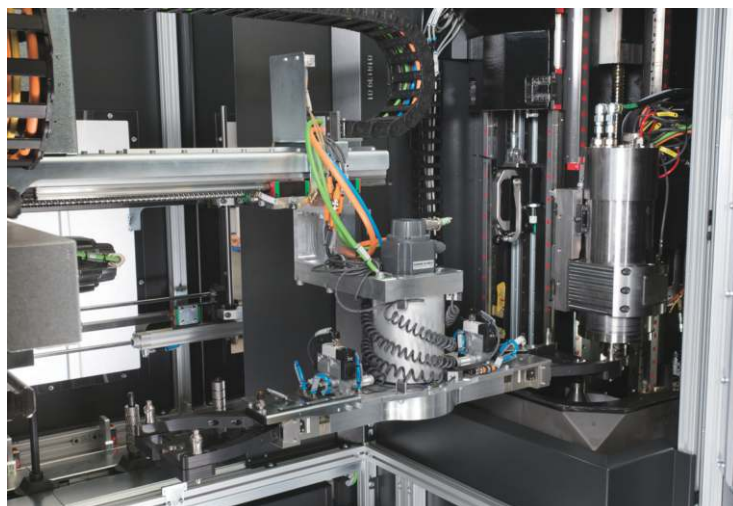
通过集成式回转上料机直接装载工件
