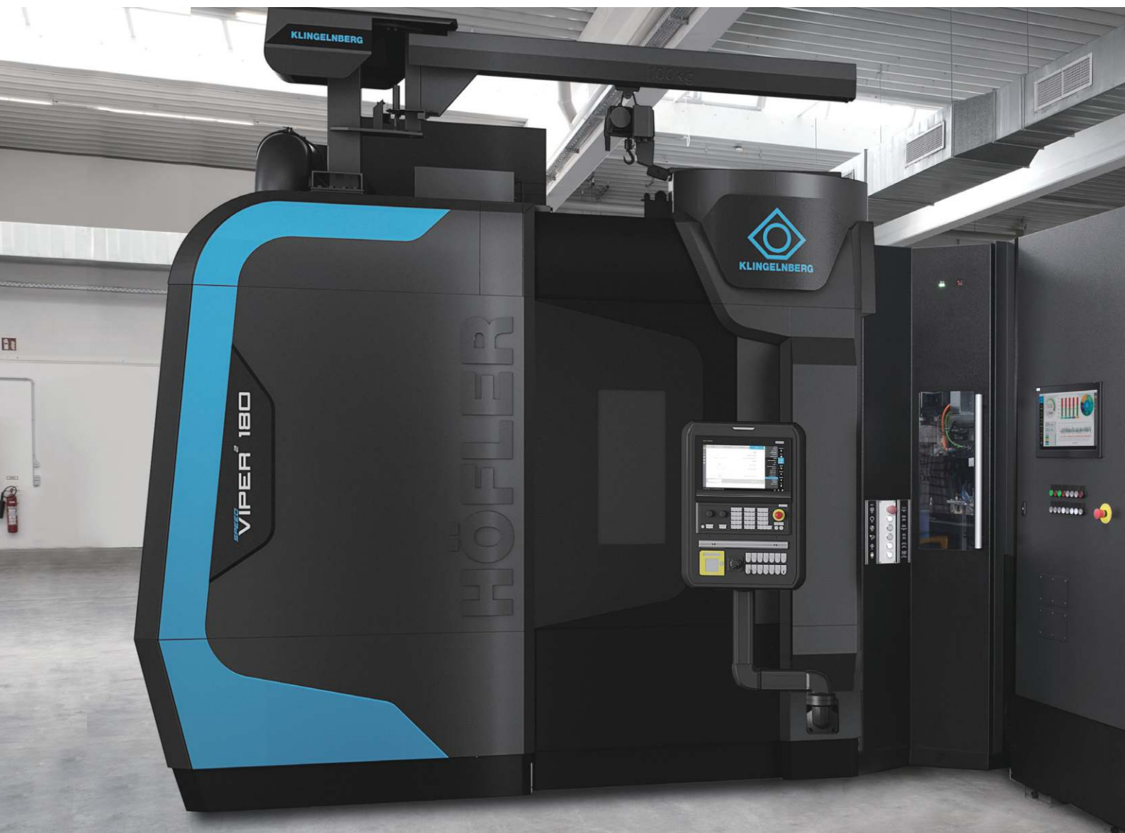
Klingelberg（克林贝格）生产单元，由Speed Viper、紧凑型上料机和R300组成自动化
