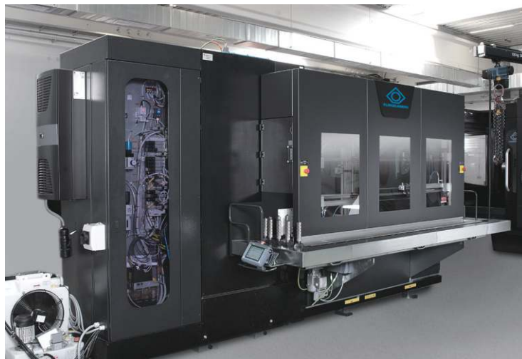
使用 KOENIG 紧凑型上料机的自动化概念——也可以选择任意第三方自动化
