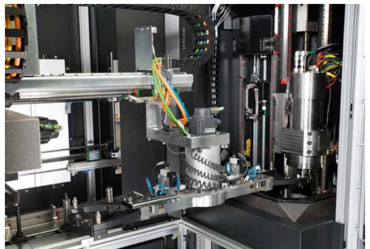
Direktbeladung der Werkstückspindel durch den integrierten Schwenklader
