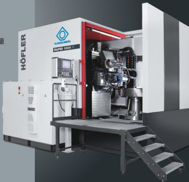
Hoefler (霍夫勒) RAPID 1600型圆柱齿轮磨齿机可加工直径高达1600mm的工件
