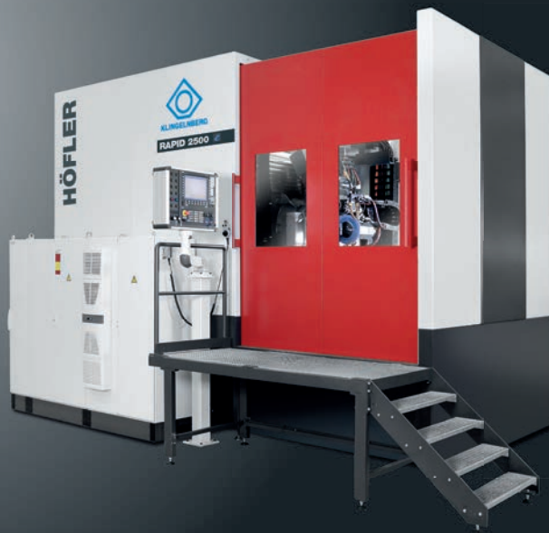
Höfler Stirnrad Schleifmaschine RAPID 2500 für Bauteildurchmesser bis zu 2.500 mm
