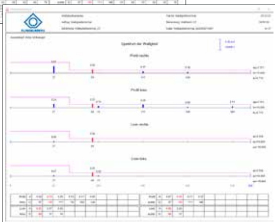
Analyse des Spektrums der Welligkeit mittels der erweiterten Standardmessung (4+4)
